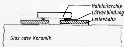
Bild 12. Hybrid-Schaltung vom Typ flip-chip
